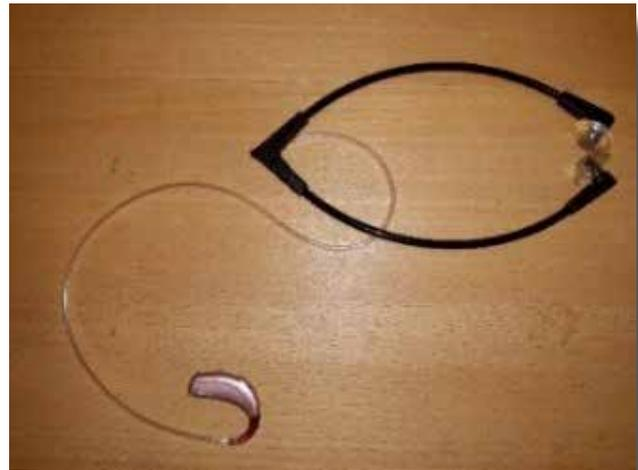
Mit dem Stethoclip wird das Hörgerät „abgehört“.
