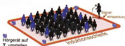
Abb. 2: Höranlage in einem Vortragsraum.
