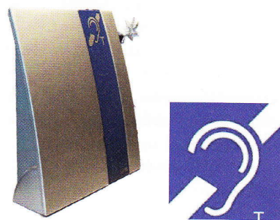
Abb. 3: Induktive Höranlage im Servicezentrum der Akademie für Hörgeräte-Akustik. Abb. 4: Dieses Hinweiszeichen zeigt an, dass eine induktive Höranlage vorhanden ist.
